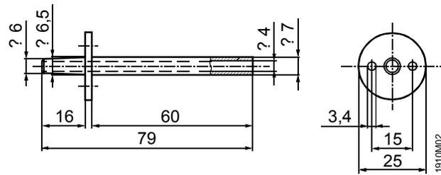
顶部导管安装支架
